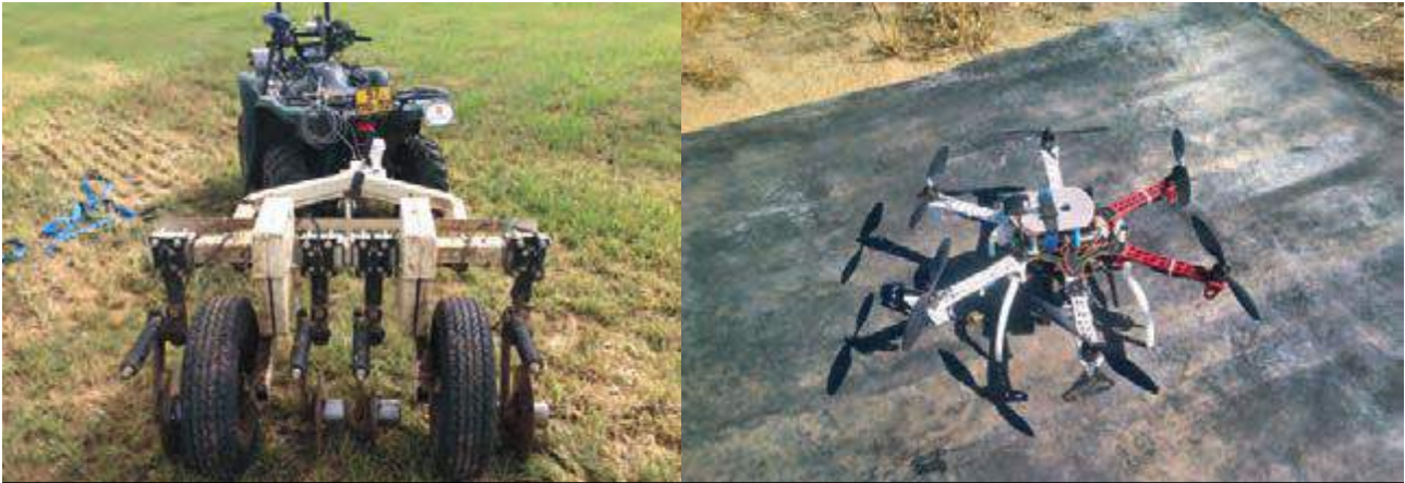
Figura 1. Sensor de contacto Veris para la determinación de ECA (izquierda) y dron utilizado para la detección remota.
